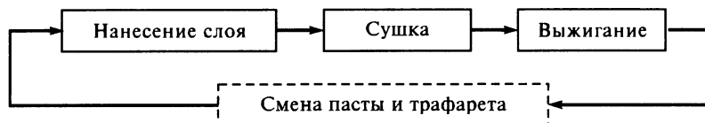
Рис. 7.26. Структурная схема цикла толсто пленочной технологии
