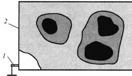
Рис. 5.20. Распределение электрического потенциала по сплошной земляной поверхности печатной платы:
