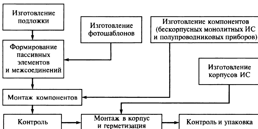
Рис. 7.2. Укрупненная схема ТП изготовления гибридно-пленочных ИС
