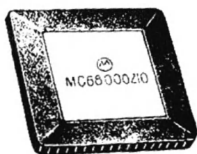
Рис. 7.45. Керамический безвыводной микрорпус (а) и микрорпуса с матрицей выводов (б)
